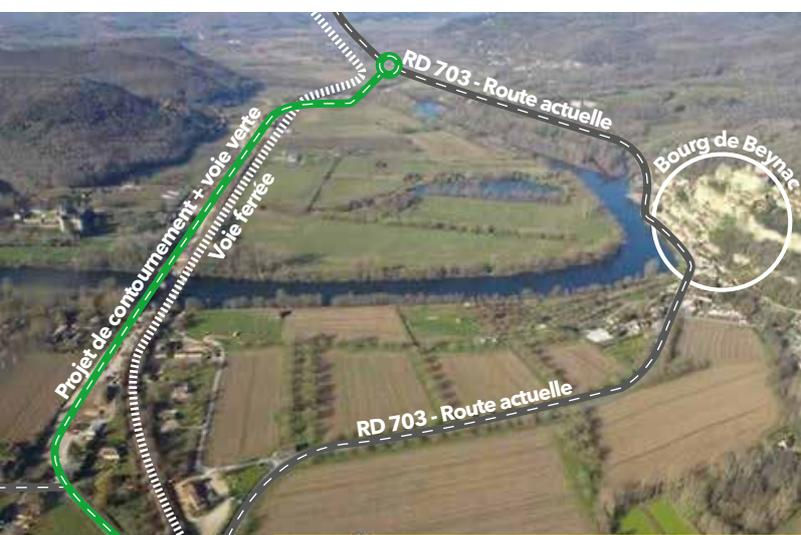
Un contournement et une voie verte destinés à protéger l'un des plus beaux villages de France. Le tracé suit, sur 3,2 km, la voie ferrée construite en 1882, avec deux ouvrages d'art et permettrait de dévier plus de 70 % du trafic de transit du cœur du bourg de Beynac-et-Cazenac.
