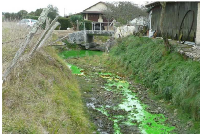
Photo 3 : Pertes du Manoire à St-Pierre de Chignac lors d'un traçage à la fluoresceïne
