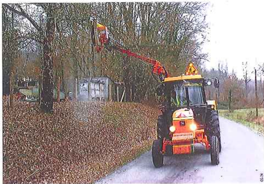
Photo 3 Le lamier, pour élaguer avec soin les branches d'arbres Cutting machine used for careful pruning of trees
